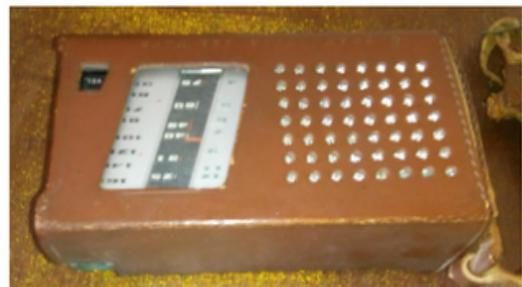
Una radio a transistores es un pequeño receptor de radio portátil que utiliza circuitos electrónicos a base de transistores. Tras el desarrollo en 1954, las radios a transistores se convirtieron en el dispositivo de comunicación más popular de su tiempo, Su reducido tamaño disparó un cambio en los hábitos de las personas al permitirles escuchar música y noticias donde quiera que fueran.
