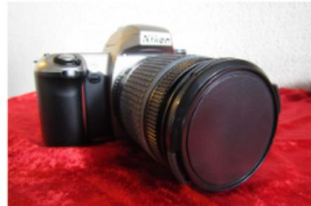
Una cámara réflex es una cámara fotográfica en la que el usuario (el fotógrafo) ve directamente la imagen que va a fotografiar a través de un visor óptico sin ninguna clase de error de paralaje.
