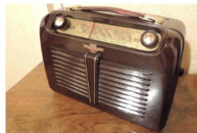
La radio LMT Weekend fué la primera radio de válvulas, alimentada con baterías. que se podía transportar. Una auténtica innovación para la época que permitía llevarla, por ejemplo en el coche y amenizar los viajes largos
