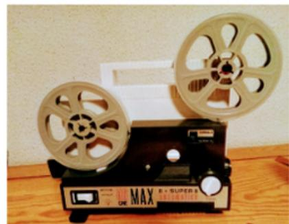
Las películas de 8mm y Super 8 se podían visualizar en proyectores. La película pasaba de una bobina a la otra pasando sobre la luz de una lámpara.
