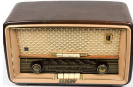
La radio a válvulas son receptores que se fabricaron después de la radio galena. En 1907, se inventa la válvula que modula las ondas de radio y de esta manera crean ondas de alta potencia en la transmisión. El empleo de la válvula triodo y sus posteriores evoluciones permitieron mejorar los receptores de radio y durante mucho tiempo se utilizaron las válvulas en todas las radios hasta que se inventó el transistor.
