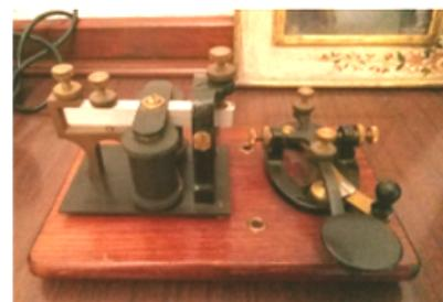
Es un transmisor con pulsador para telegrafo, fabricado por Signal Electric Mfg. Co. Menominee Michigan (1919) U.S.A. mide 18 cm de largo por 11 cm de ancho. la base es de madera y los componentes de bronce y hierro. En la base lleva un diagrama que explica la forma de conectarlos con las baterías en serie. Estos manipuladores se usaban a principios de siglo XX, en las Estaciones de Ferrocarril de Oeste Americano, cuando todavía se usaba el Telégrafo.
